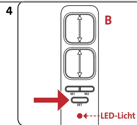
SET-Taste des Funkhandsenders B 9 Sek. lang gedrückt halten. Die Synchronisation ist abgeschlossen, wenn das LED am Funkhandsender rot leuchtet.
