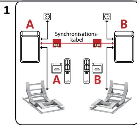
Basisstationen von den Steuerboxen trennen, dann Synchronisationskabel an die beiden Steuerboxen anschliessen
