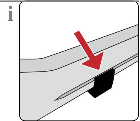
Die Klammern am Kabel können unten am Einlegerahmen Querteil mit Nut neben Motor eingerastet werden
