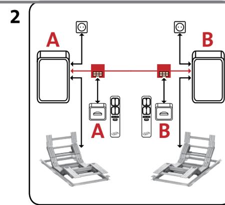
Basisstationen A und B mit dem Synchronisationskabel verbinden
