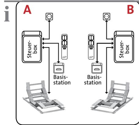
Ist-Zustand Einzel-Modus: Motoren sind nicht synchronisiert
